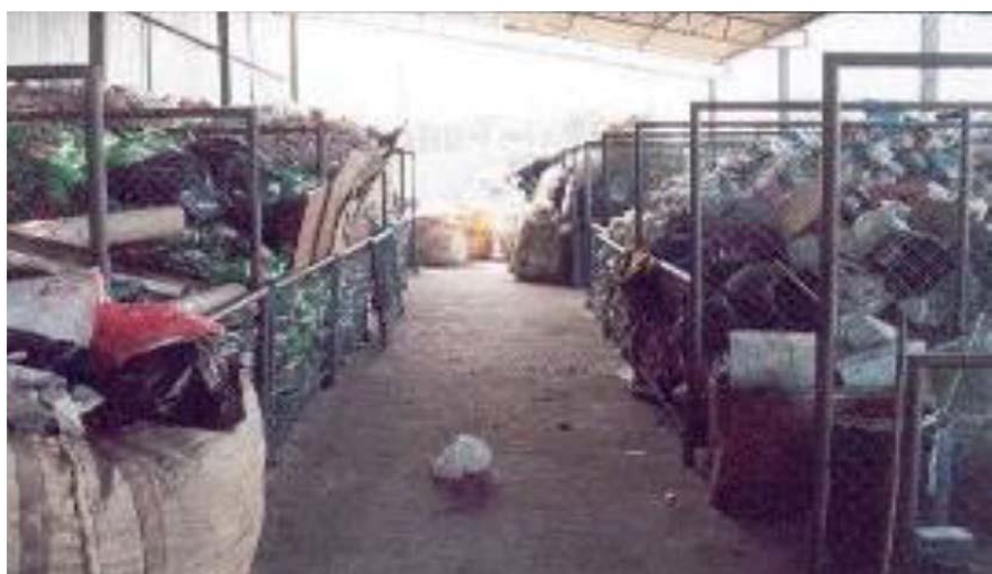
Figura 38 – “Layout” e modelo de baia em galpão de triagem – modelo MMA
